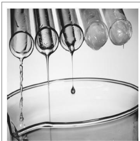
Слика 5.1. Истицање течности различитих вискозности.
